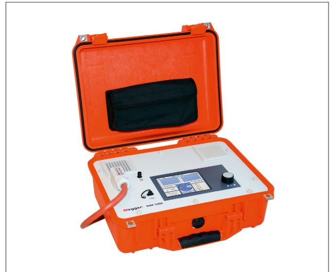
Un segundo campo de aplicación del equipo lo constituye la búsqueda de fallos en la red de baja tensión. Así, con el NIM 1000 puede provocarse un fallo como, p.ej., un fallo en el conductor neutro, un mal contacto o un fallo dependiente de la carga, y después prelocalizarse con ayuda de un equipo de medición conectado simultáneamente.
