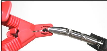
Pinza Megger que se prueba con el dedo de prueba según norma IEC para verificar contacto a prueba de toques.
