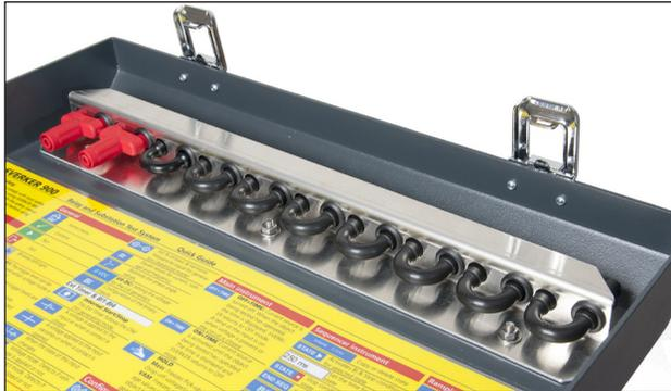
Dentro de la tapa se incluyen diez puentes insertos en soportes, una lapicera para la pantalla táctil y la guía rápida.
