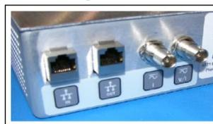
Figura 84 Señales de panel de control y puertos de comunicación montados en panel trasero SMRT1
