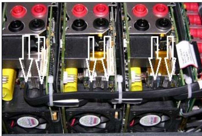
Figura 122 Conexiones Cable de Comunicación
