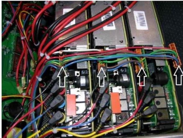
Figura 157 VIGEN Conectores de alimentación de 3 Unidad de canal
