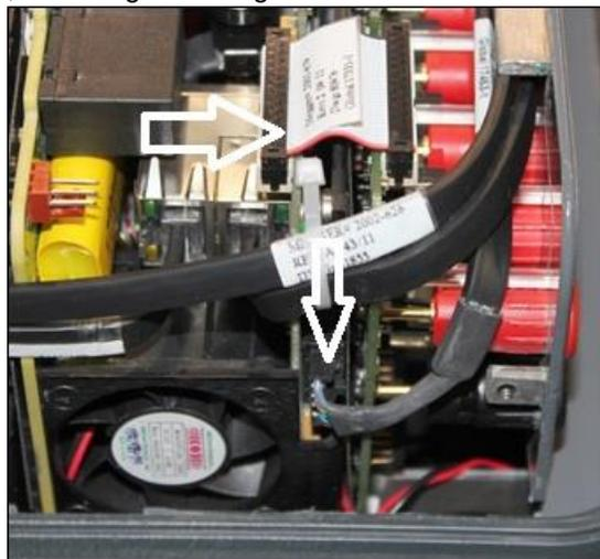
Figura 145 VIGEN1 a Cable del panel frontal
