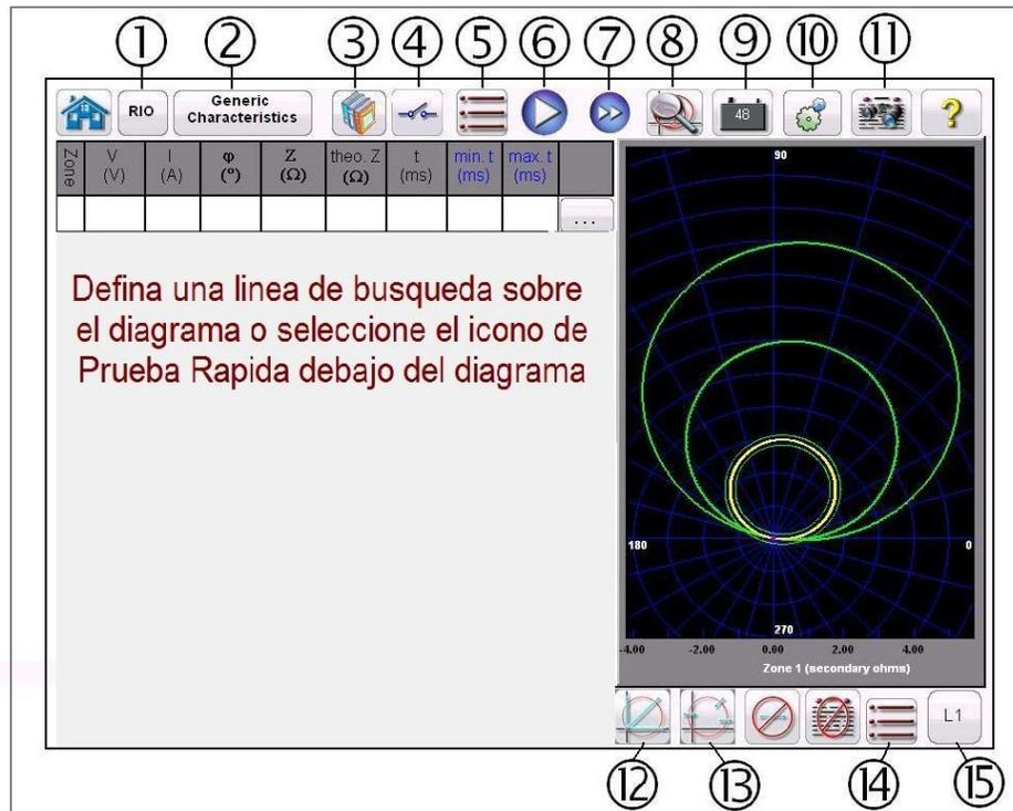
Figura 69 Pantalla de prueba de relé de impedancia, clic en falla
