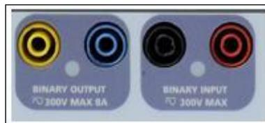
Figura 164 MPRT2145 entrada y salida binaria
