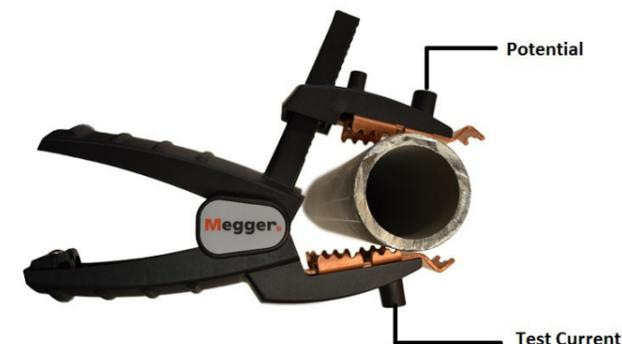
Las pinzas Kelvin universales hacen que las conexiones con transformadores sean fáciles y seguras, utilizando un cable en lugar de los dos cables tradicionales. Abertura máxima: 4 pulg. (10 cm) Incluidos: dos entradas de enchufe tipo banana para conexión de cable a muestras pequeñas.
