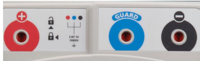
Especificación de CATIV 1000 V sobre los terminales de la unidad MIT1525, mostrados arriba. MIT515, MIT525, y MIT025 tienen especificación CATIV 600 en todos los terminales.
