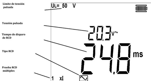
La tensión pulsada se calcula a partir de la corriente de disparo nominal del RCD x resistencia de Tierra. Por ejemplo:
