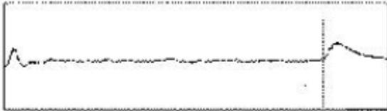
Ondas típicas de caída por fallo resistivo por debajo de la línea plana de referencia del pulso.
